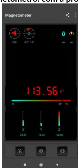
Fig. 6 – Uso do magnetômetro: com a proximidade do Bombril.
